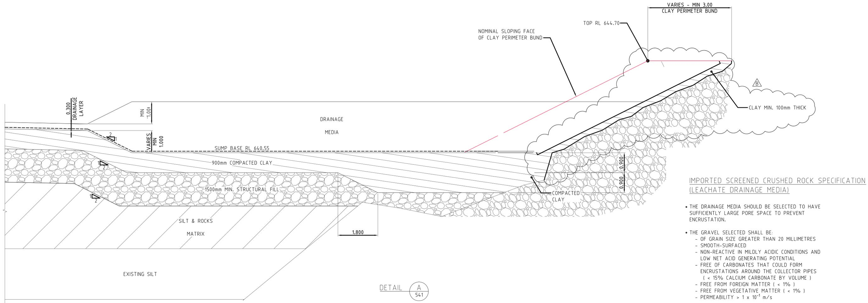
**IMPORTED SCREENED CRUSHED ROCK SPECIFICATION (LEACHATE DRAINAGE MEDIA)**
